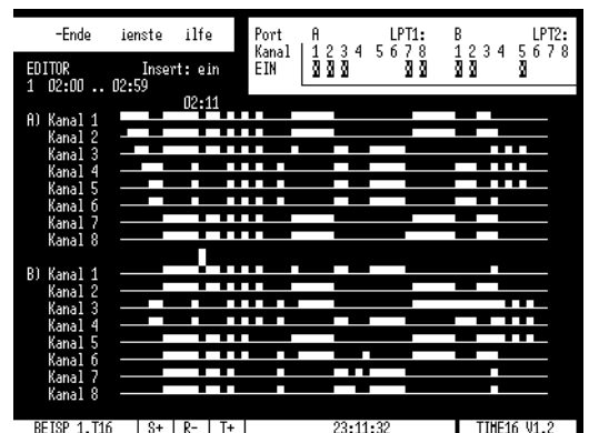
Arbeitsbildschirm im Modus EDITOR während der Programmierung des Schrittdiagramms.
